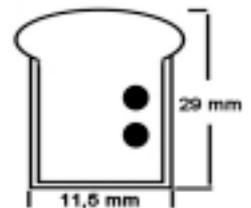
**24 Volt DC - Abmessungen 11,5x29 mm**
